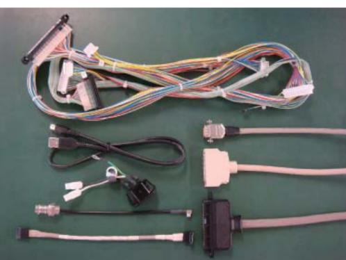
ワイヤーハーネスとは複数の電線を束ねた部品の一つで、見た目が馬をコントロールする馬具の一種「ハーネス」に似ていることから、こう名付けられました。多くは電線と接続用のコネクタ・端子で構成されており、各種電気機器の内部配線に用いられます。
