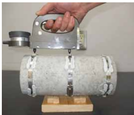
コンタクトゲージによる測定状況
