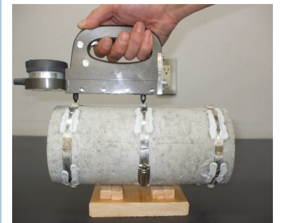
コンタクトゲージによる測定状況
