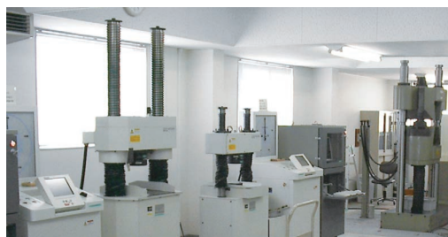
コンクリート圧縮試験
