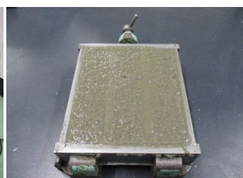
モルタルバー法 試料作製状況
