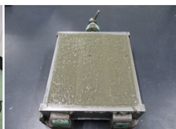
モルタルバー法 試料作製状況
