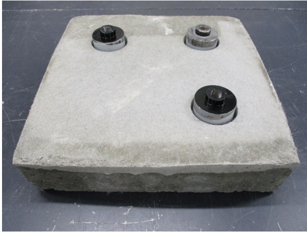
コア抜き・治具取付後
