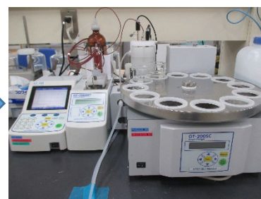
電位差滴定法による測定状況
