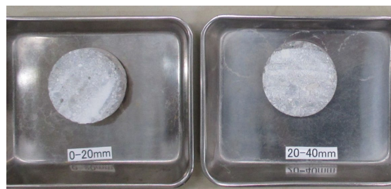
加工後のコンクリート供試体 (20mmピッチでカット)
