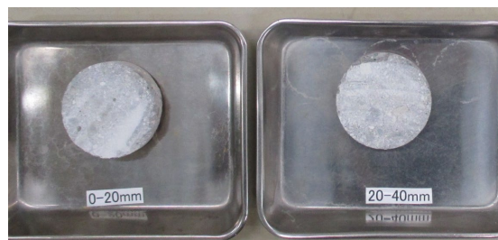
加工後のコンクリート供試体 (20 mmピッチでカット)
