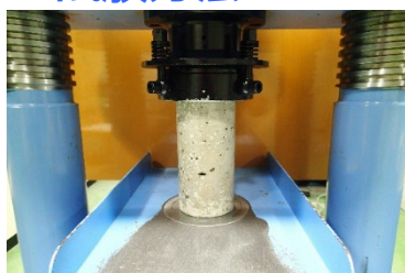
圧縮強度試験
