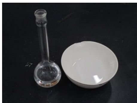
溶解性蒸発残留物の量の測定
