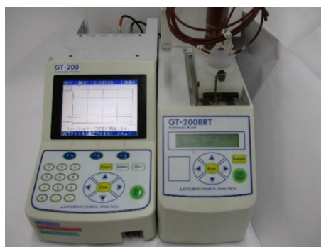
塩化物イオン量の測定
