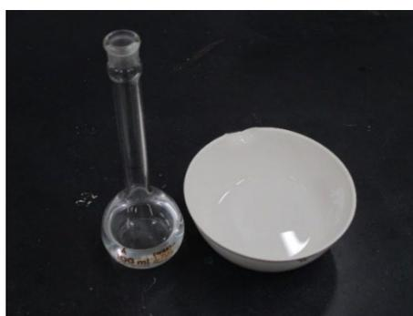
溶解性蒸発残留物の量の測定
