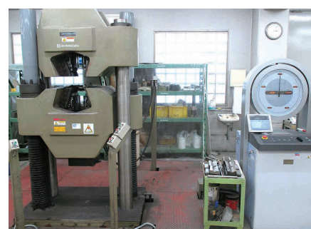
金属棒鋼引張試験
