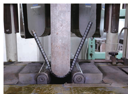
金属棒鋼曲げ試験
