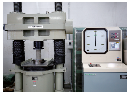
圧縮強度試験
