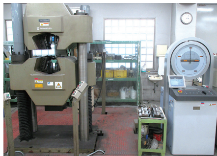
金属棒鋼引張試験
