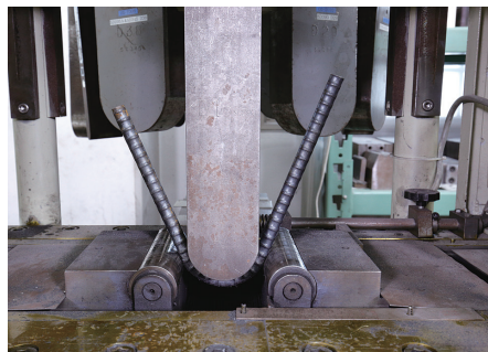
金属棒鋼曲げ試験
