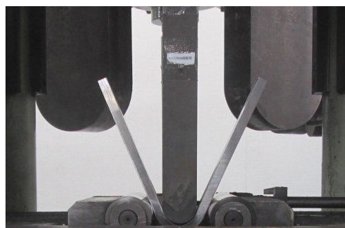
突合せ溶接曲げ試験状況
