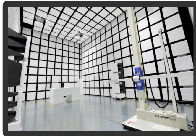
- 3m法電波暗室 -
